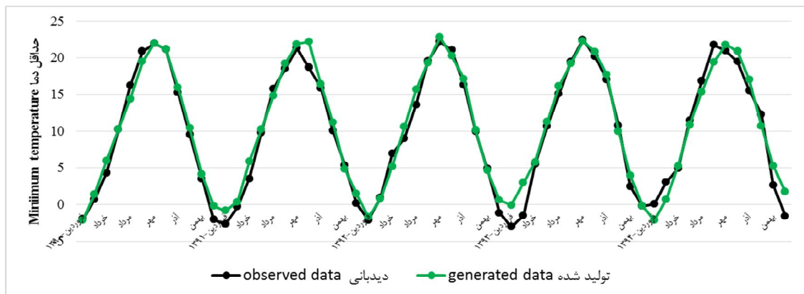
شکل 4- مقایسه مقادیر ماهانه حداقل دما برای داده‌های تولید شده و دیدبانی در دوره 94-1390 (یافته‌های تحقیق) Figure 4- The comparison of the monthly minimum temperature values for generated and observed data in period of 2011-2015 (research results)
